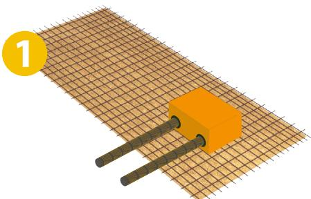
Pose des boîtes directement sur le treillis soudé (maintien par ligature).
